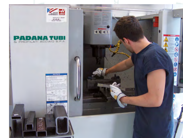
Fresa CNC per preparazione provini CNC profile milling machine for test samples
